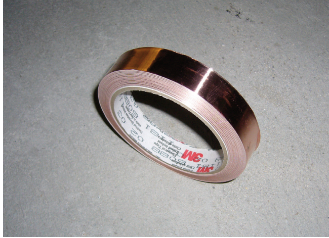
2 Taśma miedziana (samoprzylepna) do wykonania siatki odprowadzającej ładunki elektryczne.
