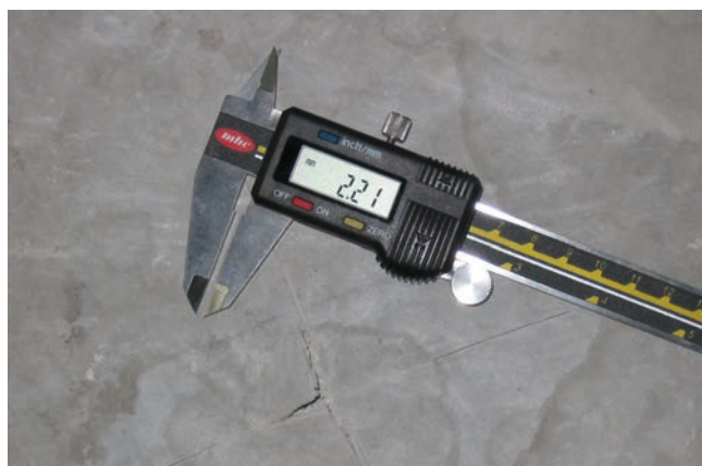
Suwmiarka do pomiaru grubości powłoki uszczelnienia.
