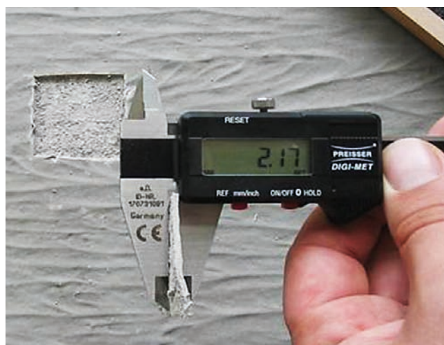
Grubość warstwy pobranej próbki określa się za pomocą suwmiarki.
