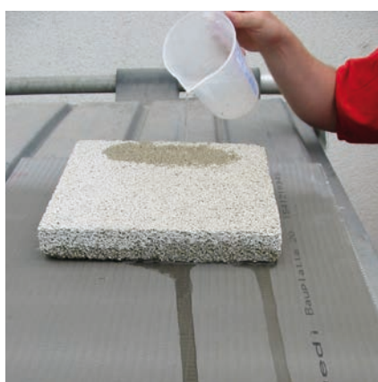
Wysoka wodoprzepuszczalność zaprawy drenażowej Sopro DM 610.
