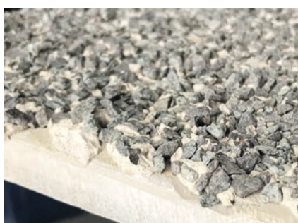
Dobrze widoczne kruszywo grysowe, osadzone na spodzie płyty.
