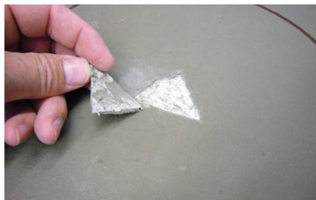
Wycinek uszczelnienia do określenia grubości warstwy.
