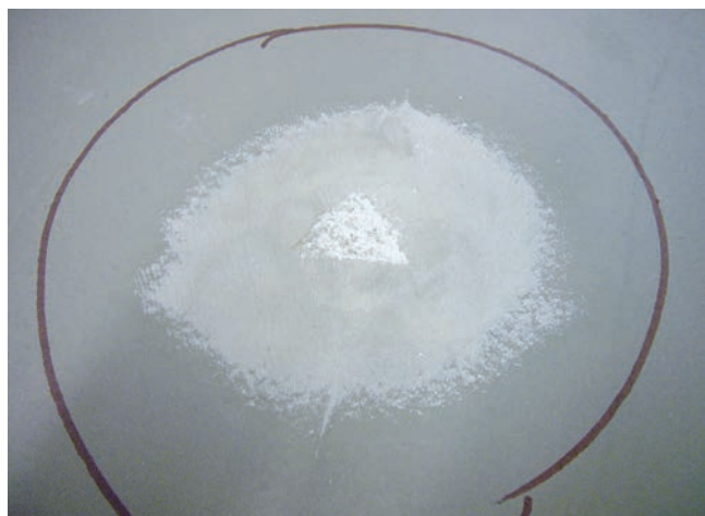
Zeszlifowana powierzchnia wokół punktu pomiarowego.
