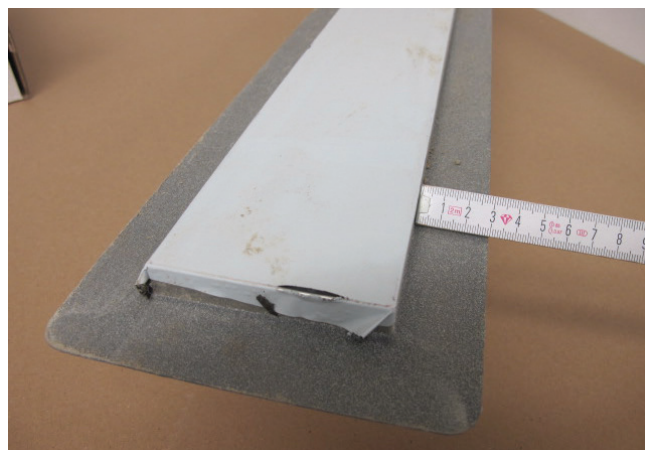
Odpływ podłogowy lub odwodnienie liniowe z 30 mm kołnierzem.
