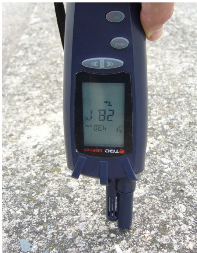
Pomiar temperatury elementu konstrukcyjnego.
