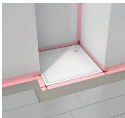
Montaż brodzika prysznicowego, którego górne krawędzie zlicowane są z powierzchnią podłogi w łazience.
