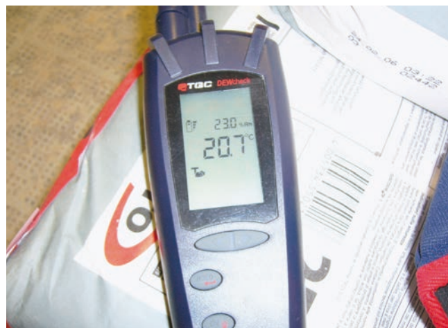
Pomiar temperatury powietrza i wilgotności względnej.
