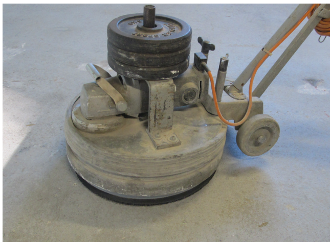
Przygotować podłoże metodą szlifowania lub frezowania.
