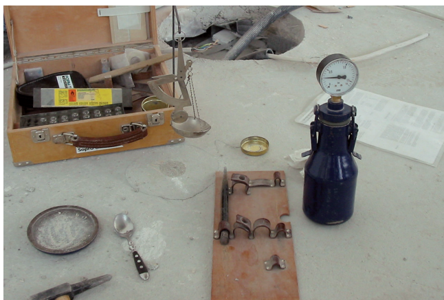
Oznaczenie wilgotności jastrychu przy pomocy urządzenia CM.
