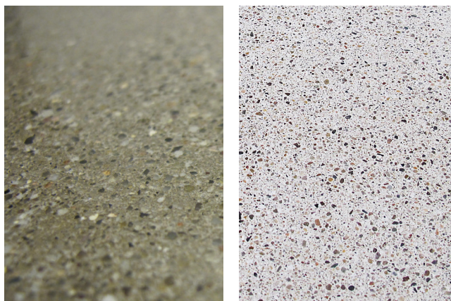
Dzięki szlifowaniu i polerowaniu uzyskuje się zwartą, atrakcyjną wizualnie powierzchnię, przypominającą lastrico.
