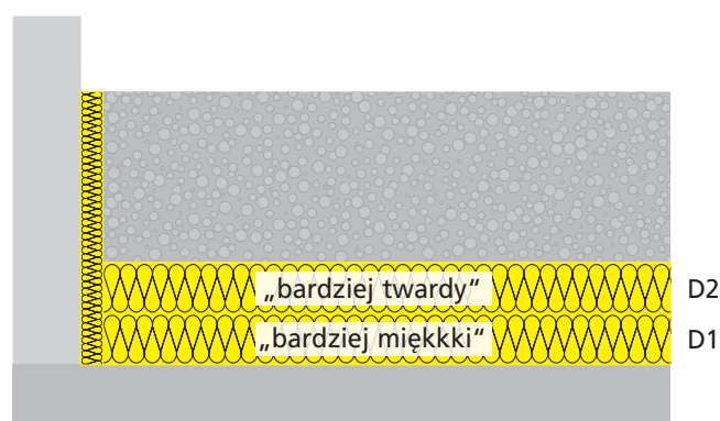
Jeżeli tworzy się kombinację izolacji termicznej i akustycznej, w górnej części powinien znajdować się materiał „twardszy”.
