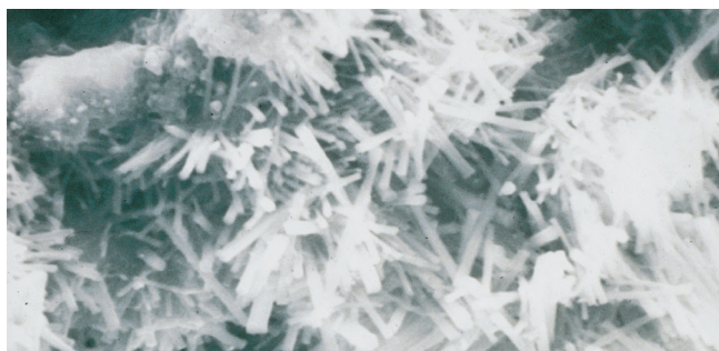
Tworzenie się etryngitu w tradycyjnej zaprawie cienkowarstwowej, w strefie zetknięcia się z jastrychem anhydrytowym (na bazie siarczanu wapnia).
