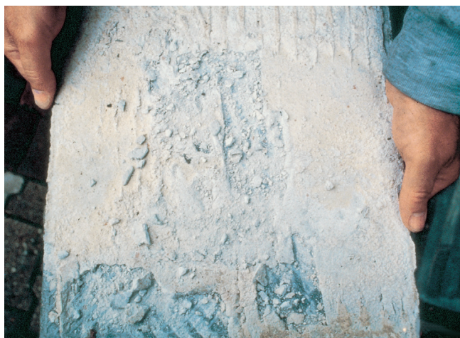
Utrata przyczepności spowodowana utworzeniem się etryngitu.
