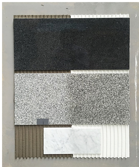
Test z użyciem szarej i białej zaprawy. Również białe zaprawy klejowe mogą powodować przebarwienia, jeżeli nie są szybko wiążące.
