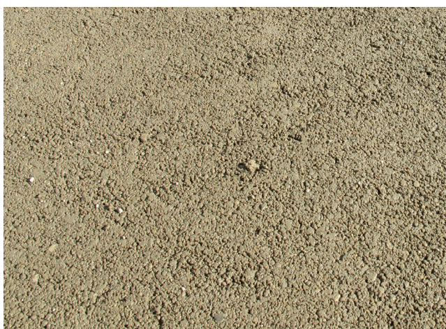
4 Zaprawa drenażowego po związaniu, o otwartej, wodoprzepuszczalnej strukturze.
