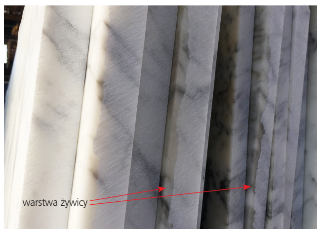
Płyty potraktowane żywicą na powierzchni.
