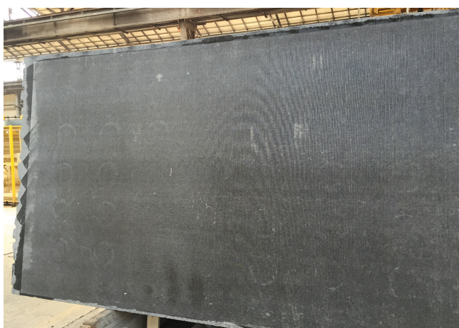
Tyłna strona płyty wzmocniona od spodu siatką zatopioną w żywicy reaktywnej.
