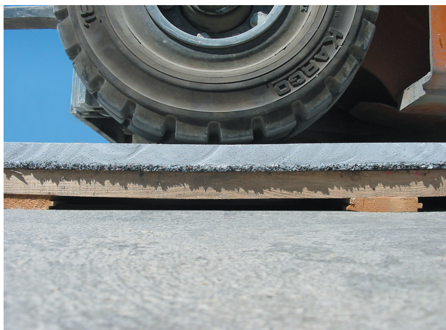
Zaprawa epoksydowa Sopro EE 771 o grubości 2,5 cm, na podłożu odkształcalnym poddana wysokim obciążeniom.
