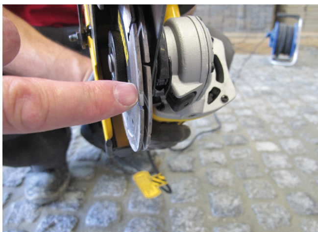
Odpowiednio dobrane tarcze pozwalają uzyskać zaplanowaną szerokość szczeliny dylatacyjnej.
